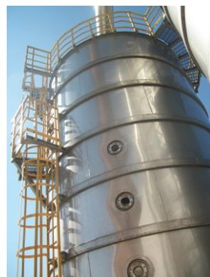
A FIBRABRAS fabrica guarda corpos com perfis pultrudados, atendendo as Norma ABNT NBR 15708-2 e NR12 podendo ser customizado conforme o projeto e necessidades dos clientes.
